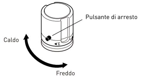
Per regolare la temperatura sopra 40 gradi, ruotare la manopola mentre si preme il pulsante di arresto
