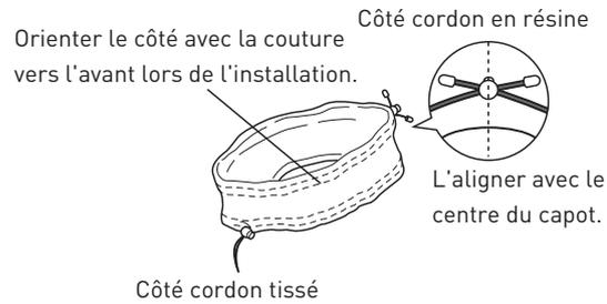
2. Fixation de la protection faciale au cadre intérieur du capot.
