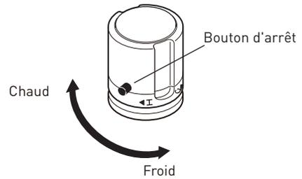
Pour régler la température à plus de 40 degrés, tournez le bouton tout en appuyant sur le bouton d'arrêt
