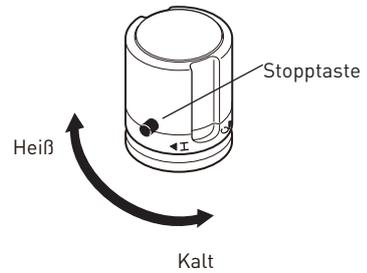
Die Stopptaste drücken und den Knopf drehen, um Temperaturen über 40 Grad einzustellen.
