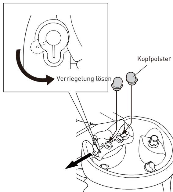
3 Lösen Sie die Verriegelung und bringen Sie das Kopfpolster nach dem Abspülen wieder an
