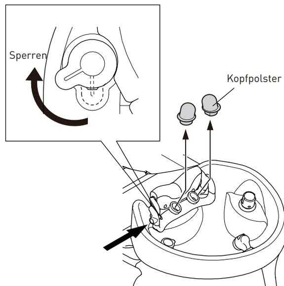
2 Verriegeln und entfernen Sie das Kopfpolster beim Abspülen
